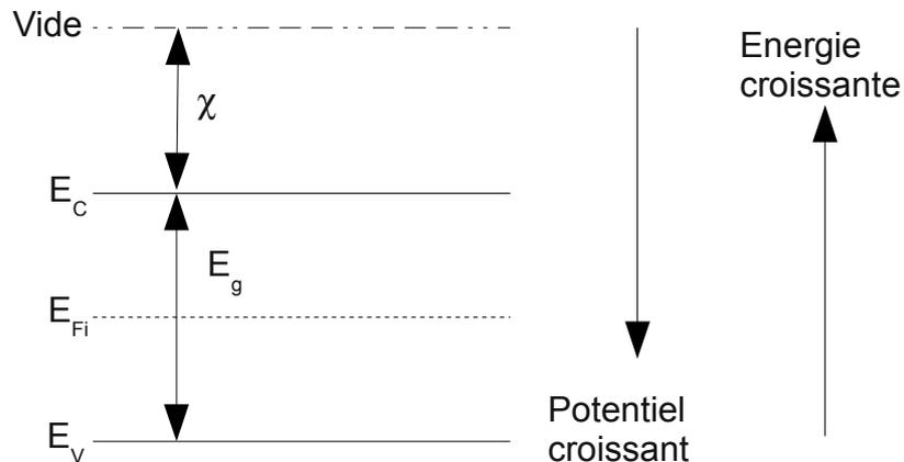
Vide,  $E_C$ ,  $E_{Fi}$  et  $E_V$  représentent respectivement les niveaux d'énergie du vide, de la bande de conduction, du niveau de Fermi et de la bande de valence.
