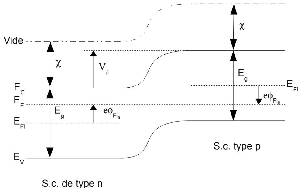
A l'équilibre thermodynamique, il apparaît une zone de charge d'espace à la jonction et une tension de diffusion :  $V_d = e \phi_{Fi_n} - e \phi_{Fi_p}$
